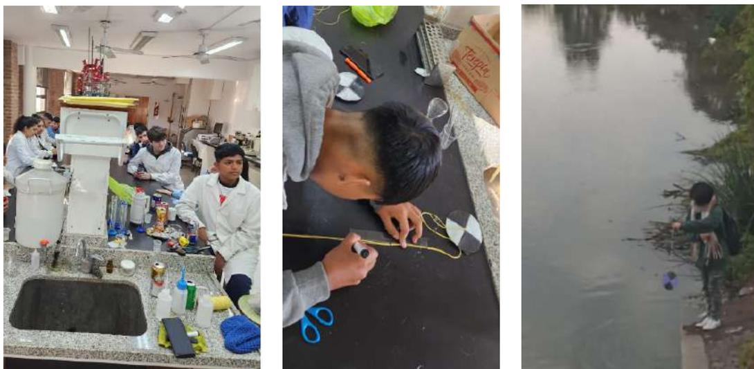
**Figura 1.** De izquierda a derecha. A partir de las indicaciones dadas, estudiantes en el laboratorio realizaron los discos de Secchi. Estudiante realizando las marcas del medidor. Estudiante utilizando disco de Secchi.
