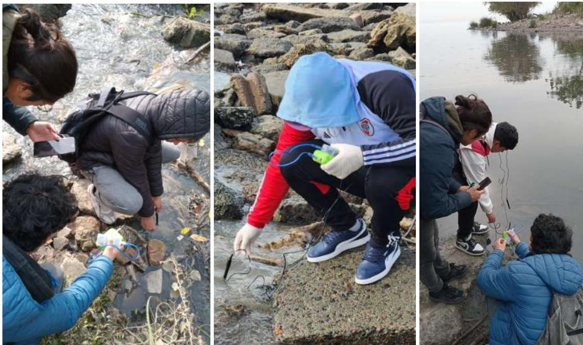
**Figura 9.** De izquierda a derecha: El estudiante Lucero Lucas de 6° T (EST-UNSAM) utilizando el medidor de oxígeno disuelto (OD) construido por el grupo CoSensores, en la conexión del arroyo Raggio con el Río de la Plata, Kevin Gonzalez de 6°T (EST-UNSAM) realizando la medición de OD en el Río de la Plata. Daniel Ferreyra de 5T, midiendo el oxígeno disuelto en el Pluvial Laprida.
