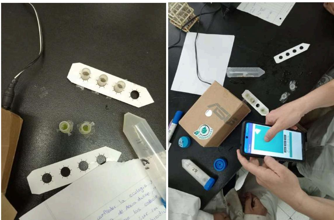
**Figura 19.** *Izquierda:* gradillas conteniendo los dispositivos expuestos a las muestras. *Derecha:* Determinación del crecimiento de las microalgas utilizando la aplicación de celular “RGBometro”.
