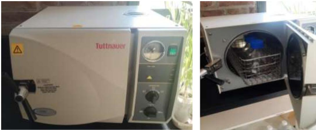
**Figura 11.** Izquierda: Autoclave cerrada. Derecha: Frascos Schott en la autoclave.
